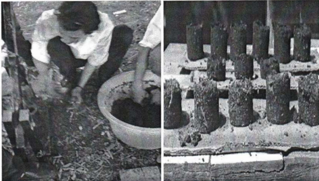
Gambar 2. Pembuatan briket menggunakan alat kempa dan briket hasil
